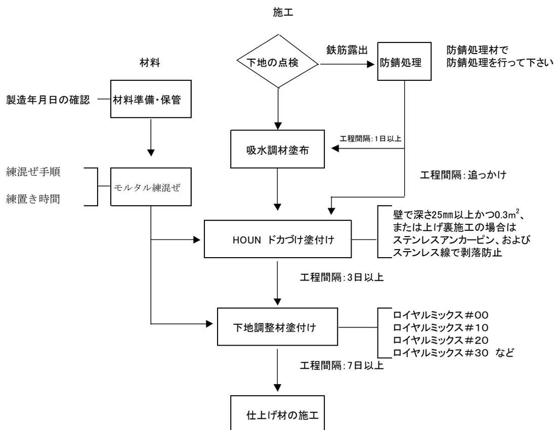
「HOUN ドカづけ」を塗付ける前に、コンクリート・モルタル面のひび割れ・浮きなどを点検し、浮きがあれば、はつり等を行って除去して下さい。「HOUN ドカづけ」の塗付けは、軽く塗付けると言った感じではなく、コテに圧力をかけて下地にすり込むといった塗り方が必要です。塗付け後、モルタルの締まり具合を見計らい、木ゴテや金ゴテで不陸のない平坦な面に仕上げして下さい。
